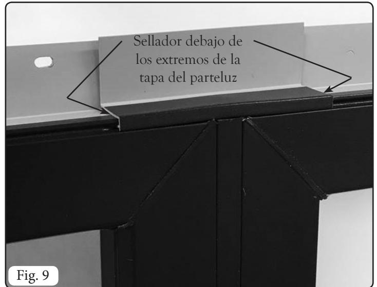
Consulte la Fig. 10. Dé vuelta la unidad y, usando un alicate o un cuchillo multiuso, retire las patas de soporte interiores del bastidor y luego aplique la cubierta interior del parteluz con un martillo de goma. Limpie el excedente de sellador antes de que se seque.
