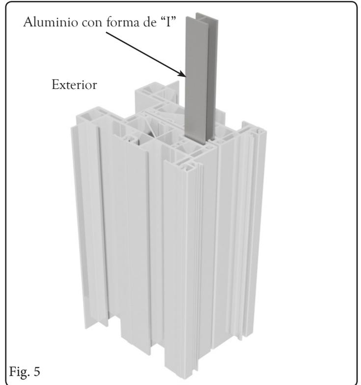
Consulte la Fig. 5. Antes de mover la unidad, deslice el refuerzo de aluminio en forma de "I" de 10" (254 mm) en ambos extremos del parteluz hasta que esté nivelado con el extremo de los bastidores. Esto sujetará los dos bastidores entre sí. Coloque sellador en los extremos del aluminio para que no se deslice por el canal al colocar la unidad en posición vertical.
